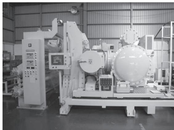
図 26 電子線ロール照射装置
