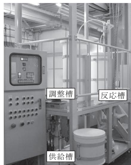
図 28 パイロットスケール陽イオン交換基導入装置
