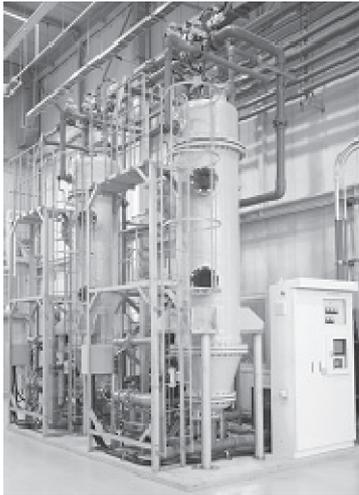
図36 パイロットスケール高速ろ過装置
