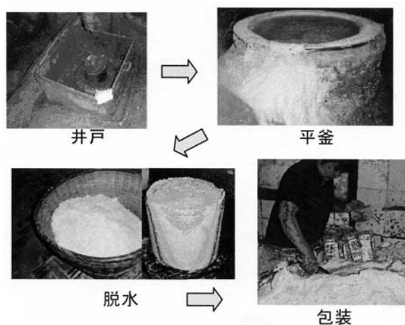
写真1 自貢に残る平釜製塩風景
