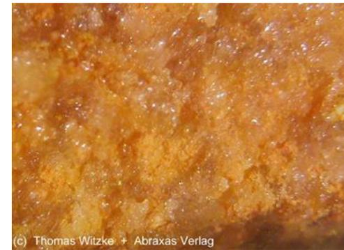
カーナライト ( $\text{KCl} \cdot \text{MgCl}_2 \cdot 6\text{H}_2\text{O}$ ) の写真
