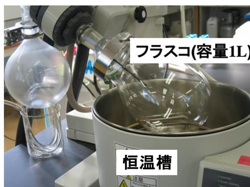
図 5 加熱蒸発晶析装置
