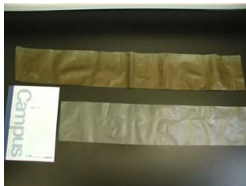
図6 電子線グラフト重合法で 合成したイオン交換膜
